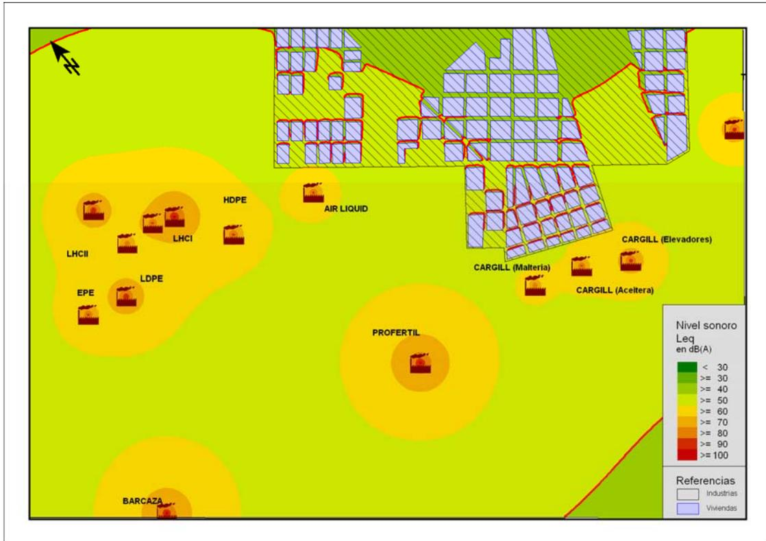
**Figura 4.** Mapa acústico de la zona bajo estudio. La línea roja determina la curva de nivel de 50 dB(A) adoptada como valor límite permisible.
