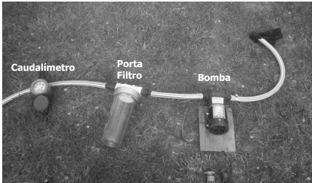
Fotografía 2. Equipo de filtración: bomba de agua, porta filtro y Caudalímetro.
