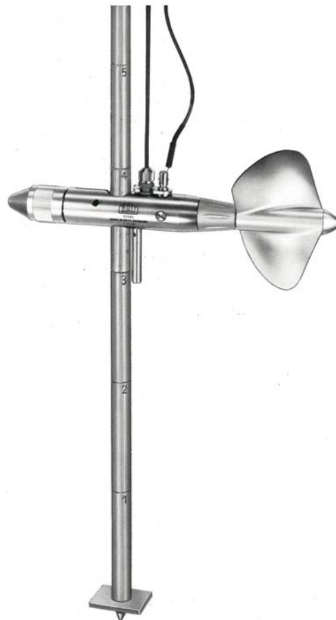
Molinete Universal Aott Kempten SN° 16695/C31
