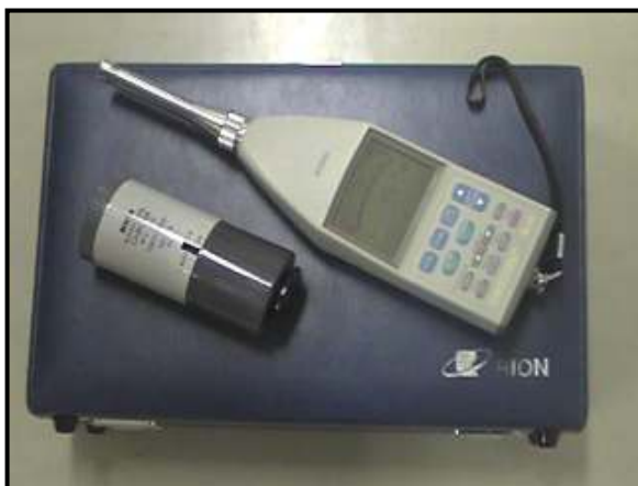
Medidor de nivel sonoro marca Rion, Modelo NL – 14. Tipo 2
