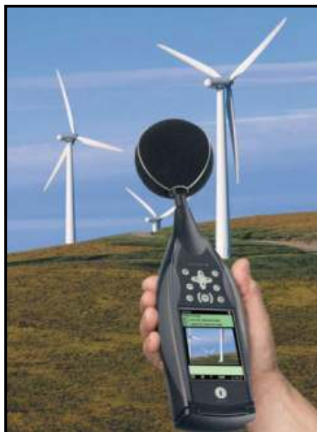
Medidor de nivel sonoro marca Brüel & Kjaer, Modelo 2270. Tipo 1
