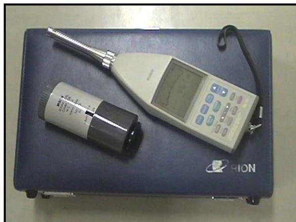
Medidor de nivel sonoro marca Rion, Modelo NL – 14. Tipo 2
