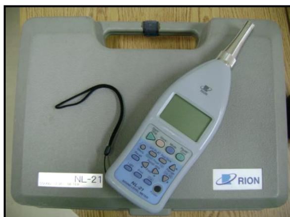
Medidor de nivel sonoro marca Rion, Modelo NL – 21. Tipo 2.
