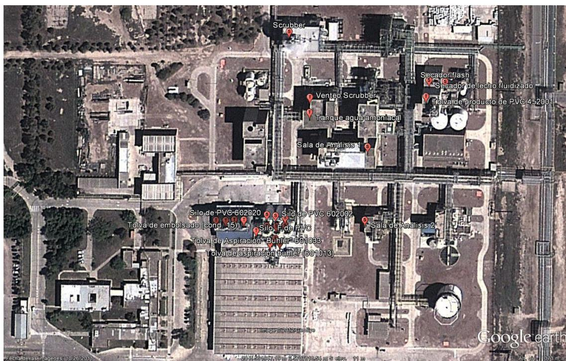
CLORO SODA: cuenta con 7 puntos de emisión a considerar: 2 calderas de generación de vapor, un calentador de sales, un venteo del aire ambiente de sala de celdas de electrólisis, un horno de destilación de Hg, una chimenea de gases de batea de lavado oxálico y la salida de gases del sistema Wsal.
