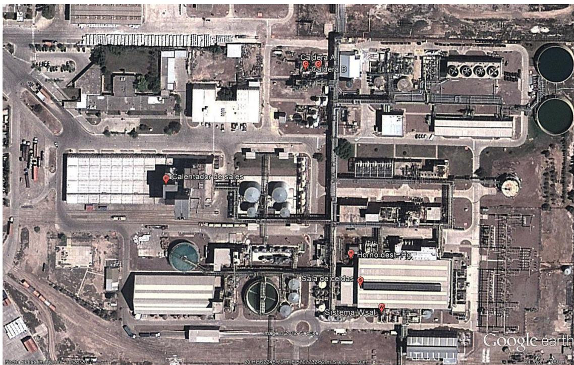
VCM: esta planta cuenta con 2 calderas, 3 hornos de crackeo térmico, un incinerador de gases efluentes y el venteo del reactor de oxiclación.
