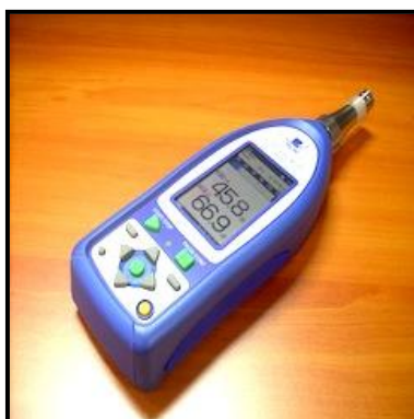
Medidor de nivel sonoro marca Rion, Modelo NL – 52. Tipo 1
