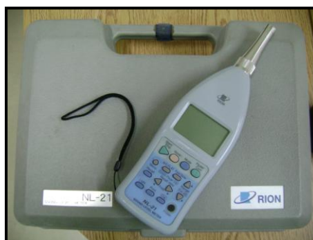
Medidor de nivel sonoro marca Rion, Modelo NL – 21. Tipo 2.
