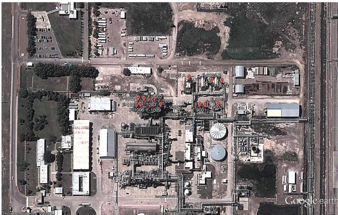
LHC II: en esta planta existen 5 hornos de crackeo térmico de etano y un incinerador cáustico para los efluentes de LHC I y II.
