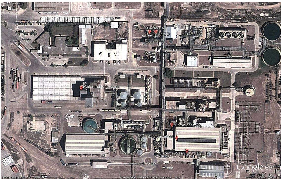
VCM: esta planta cuenta con 1 caldera, 3 hornos de crackeo térmico, 2 incineradores de gases efluentes y el venteo del reactor de oxícloración.
