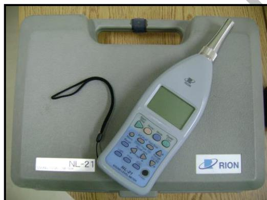
Medidor de nivel sonoro marca Rion, Modelo NL - 21. Tipo 1
