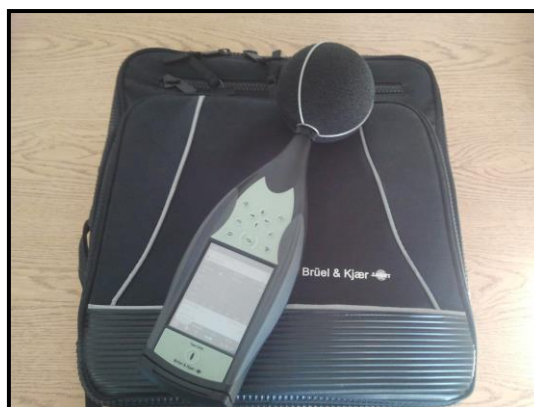
4 Medidores de nivel sonoro marca Brüel & Kjaer, Modelo 2270. Tipo 1
