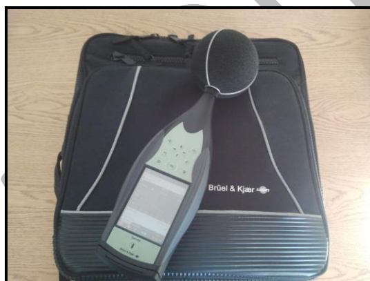
4 Medidores de nivel sonoro marca Brüel & Kjaer, Modelo 2270. Tipo 1 2 Medidores de nivel sonoro marca Brüel & Kjaer, Modelo 2250. Tipo 1
