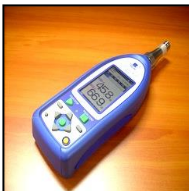
Medidor de nivel sonoro marca Rion, Modelo NL - 52. Tipo 1 Medidor de nivel sonoro marca Rion, Modelo NL - 21. Tipo 1
